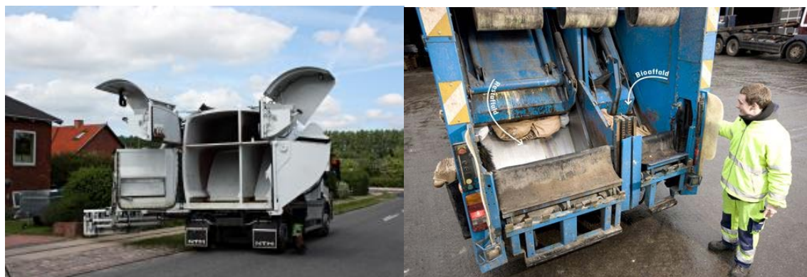
Skraldebil med fire kamre (t.v.) og med to kamre (t.h.). Foto: Vestforbrændingen
